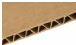
**Struttura a onda singola**
